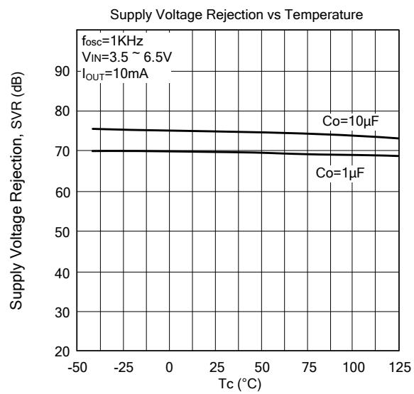
■ TYPICAL CHARACTERISTICS (Cont.) ( $T_J=25^\circ\text{C}$ ,  $C_l=1\mu\text{F}$ ,  $C_o=2.2\mu\text{F}$ ,  $C_{\text{BYP}}=100\text{nF}$ )
